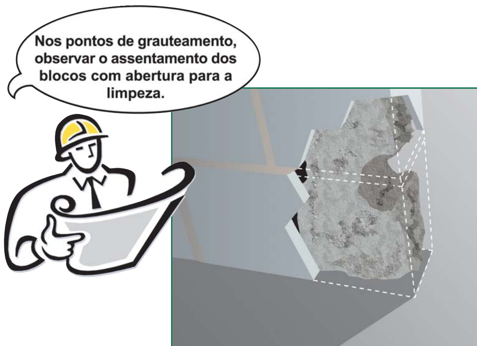
Figura 77 – Grauteamento sem limpeza
