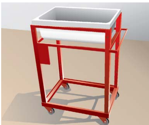
Figura 16 – Caixa de argamassa com suporte
