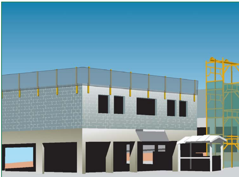
Figura 2 – Laje com proteção coletiva
