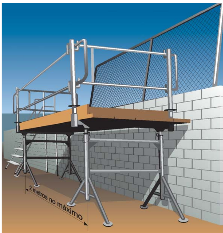
Figura 3 – Andaime com guarda corpo e altura ajustáveis
